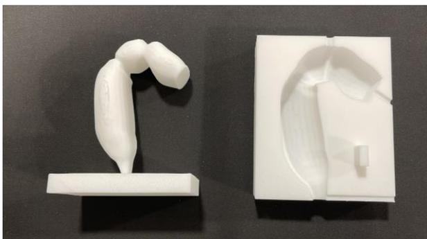
**Figura 4.** Molde en bloque de colón impreso en HIPS.
